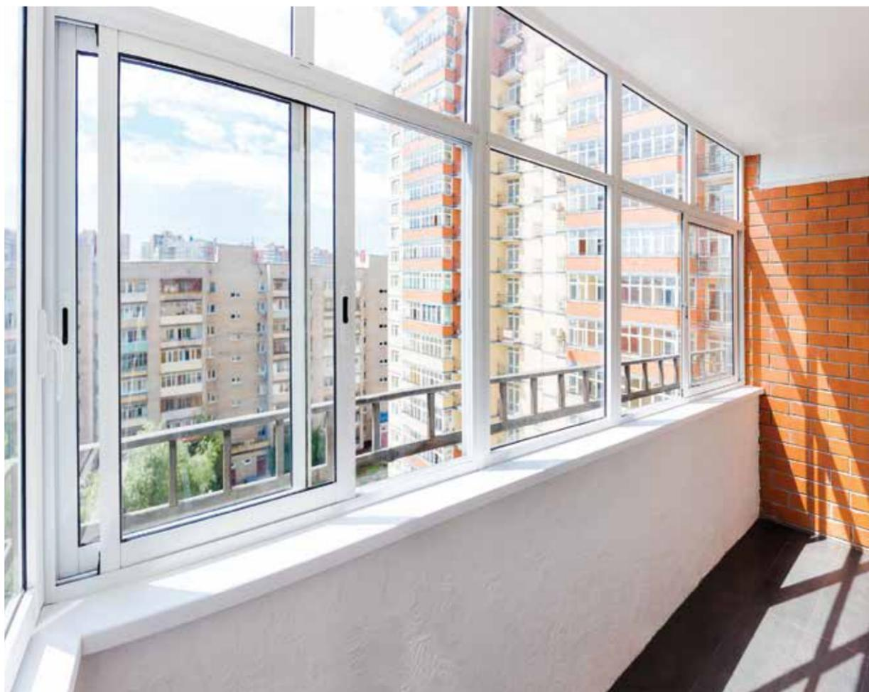
È realizzato con sistemi in alluminio ETEM E - 1600, senza ponte termico interrotto ed ETEM E - 50, con ponte termico interrotto;
